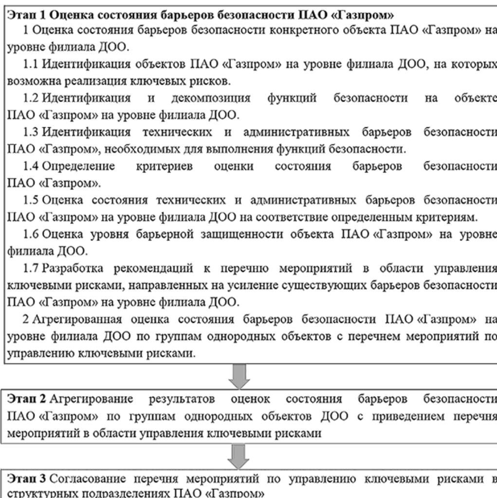
Рисунок 4.1 - Общий алгоритм оценки состояния барьеров безопасности ПАО "Газпром"
