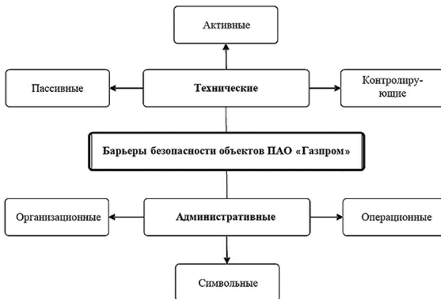
Рисунок 6.1 - Классификация барьеров безопасности ПАО "Газпром"
